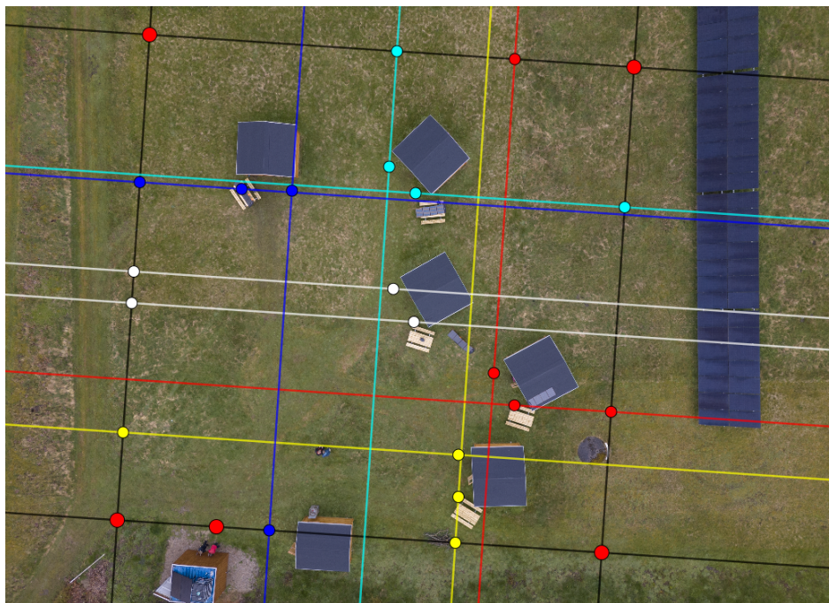
Figur 2 - Ekstra markeringer på den ydre grænse. Hver gruppe sætter to landmålerstokke vinkelret på ydersiderne fra deres to første placeringer. Den enkelte gruppes stokke er markeret med farver, der svarer til nøglefarverne til hytterne.
